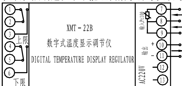
图 4.5 XMT-22B 电气连接图
